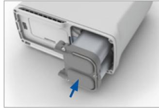
10. Empuje para introducir la columna en el dispositivo, de modo que quede completamente asentada en el concentrador Inogen One® G4. El botón del seguro con resorte debe regresar por completo a la posición cerrada.
